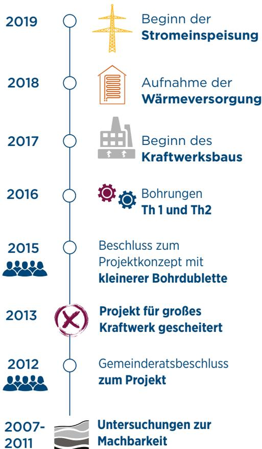
Das Projekt wurde seit 2007 intensiv vorbereitet mit Daten aus Kohlenwasserstoffbohrungen, einer 3D-Seismik, Machbarkeitsstudien und Wirtschaftlichkeitssimulationen. 2011 war geplant, Erdwärme mit ca. 150°C zur Fernwärmeversorgung im Ort und zur Stromerzeugung in einem ORC-Kraftwerk mit 5 bis 6 MWel wirtschaftlich zu nutzen.
